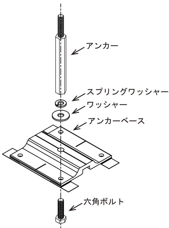
アンカーベースに六角ボルト (M8x20) を立てワッシャー、スプリングワッシャーを通し、電動ドライバーに六角ロングソケット (対辺 13 mm) を取付け、アンカーを締め込み固定します。
