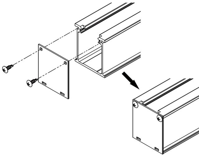
縦ラックに先端カバーを合わせ、ビス2本で固定します。
