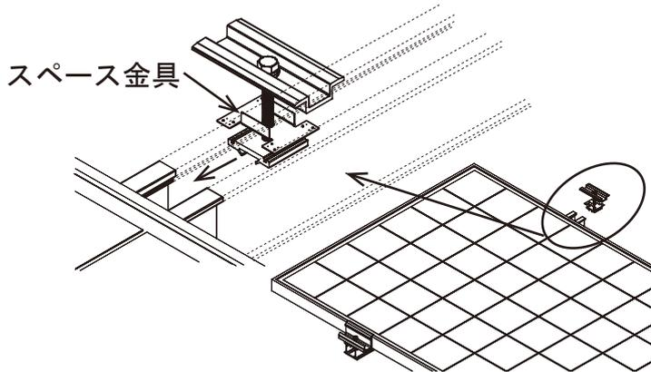
中間固定金具を縦ラックに通しスペース金具がモジュール下に入るように設置します。
