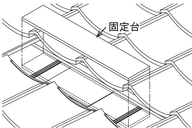
上段の瓦の先端に固定台を合わせ、垂木 2本にかかるように配置します。
