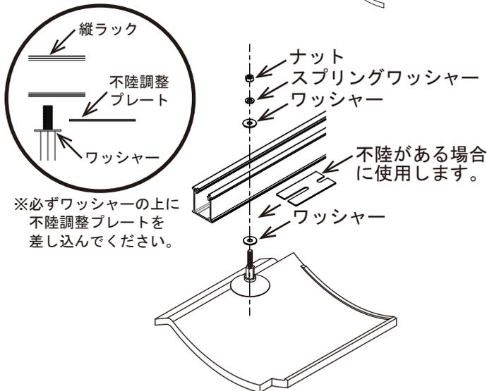
※トルク管理のできるドライバーで締付トルクは約 2.7 ~ 3.0 [N·m]。
