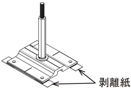
アンカーベースの剥離紙を剥がします。アンカーベースの位置だしラインと「(2) マーキング」で引いた垂直水平の線を合わせて貼付けます。
