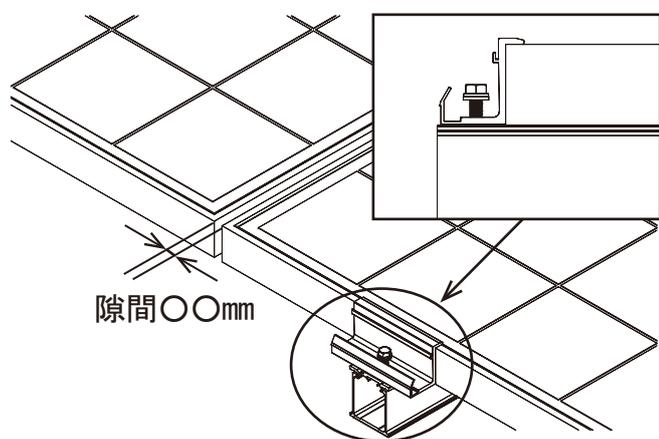
モジュールを端部固定金具に差込み仮置きします。
