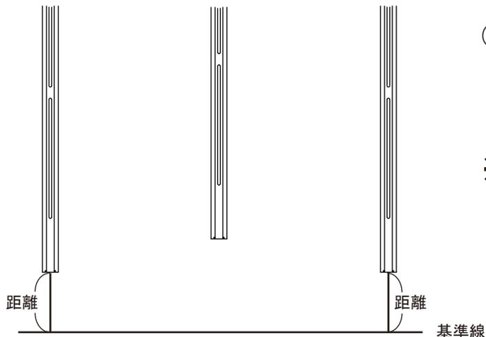
① けらば側の縦ラック先端と基準線からの距離を合わせ、平行に固定します。
