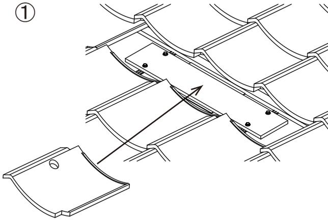
① アンカーベースを取付ける位置にマーキングするため、加工した瓦を戻します。
