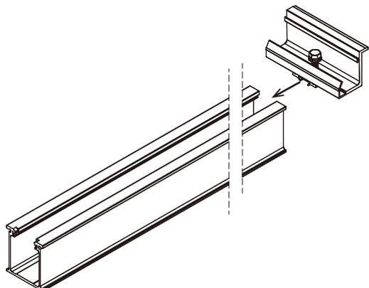
端部固定金具を棟側から挿入します。
