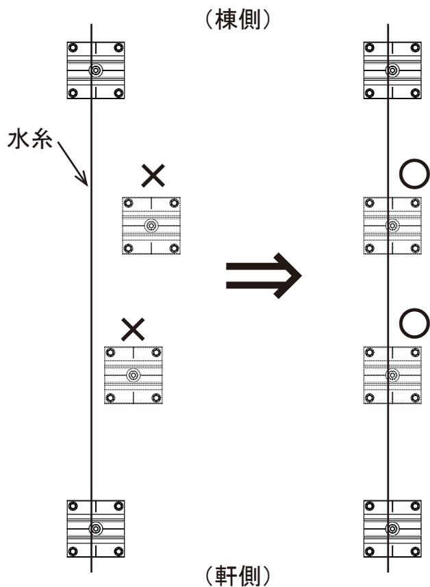
金具取付けは軒側と棟側の金具を取付けて水糸を張ります。
