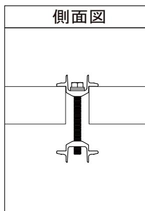
③雪止め金具（上部）ごと引張り上げ雪止め金具（下部）が太陽電池モジュールのフレームに引っ掛かっていることを確認します。
