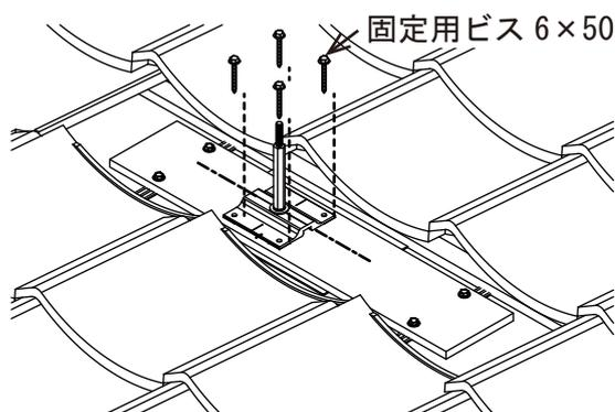
電動ドライバーに六角ソケット（対辺 10 mm）を取付け固定用ビス（6×50）4本で固定します。
