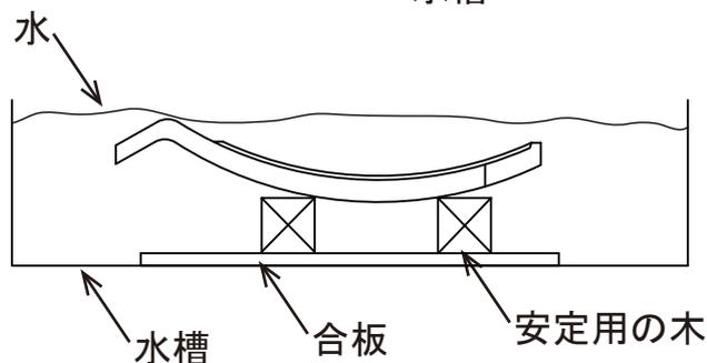
※瓦全体が浸かるまで張ることで、加工の際に出る粉塵を軽減できます。また、刃の過熱を抑え刃の寿命が延びます。
