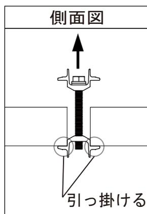
④雪止め金具（上部）を引張り上げた状態でボルトを締付けトルク 3.0 [N・m] で締込み固定します。
