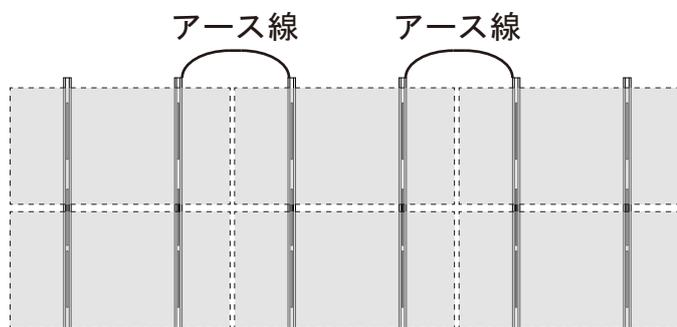
圧着端子の付いたアース線（現場調達品）を縦ラック棟側の側面にビス（現場調達）で打込み列方向のアースを取ります。
