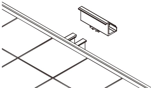
端部固定金具を通し、電動ドライバーに六角ソケット（対辺 10 mm）を取付け、ボルトを締め込みます。
