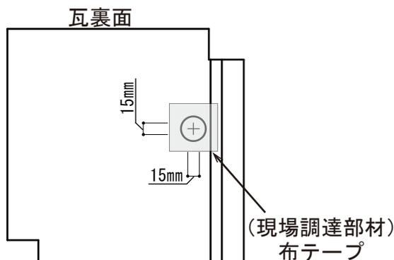
加工した穴を現場調達部材の布テープで塞ぎ、中心にアンカーが通せる程度（15 mm）に十字に切り込みを入れます。
