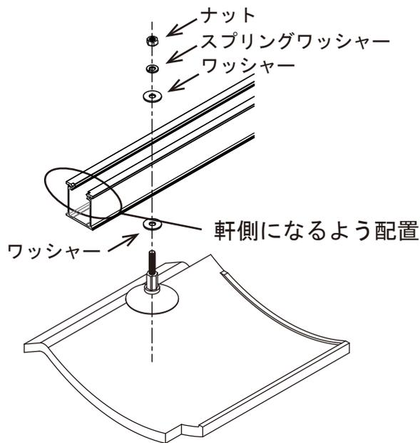
ボルトにワッシャー・縦ラックを通しワッシャー・スプリングワッシャー・ナットで仮固定します。
